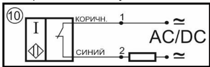
Схема соединения Нормально-замкнутый контакт
